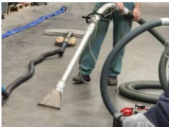
Olajleszedő szivattyú (Komora)
