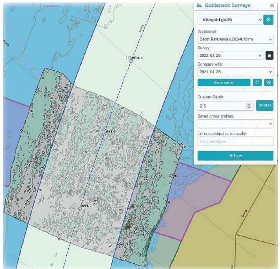
3. kép: Két különböző év eltérése a mederfenék domborzatában a WAMOS kezelői felületén
