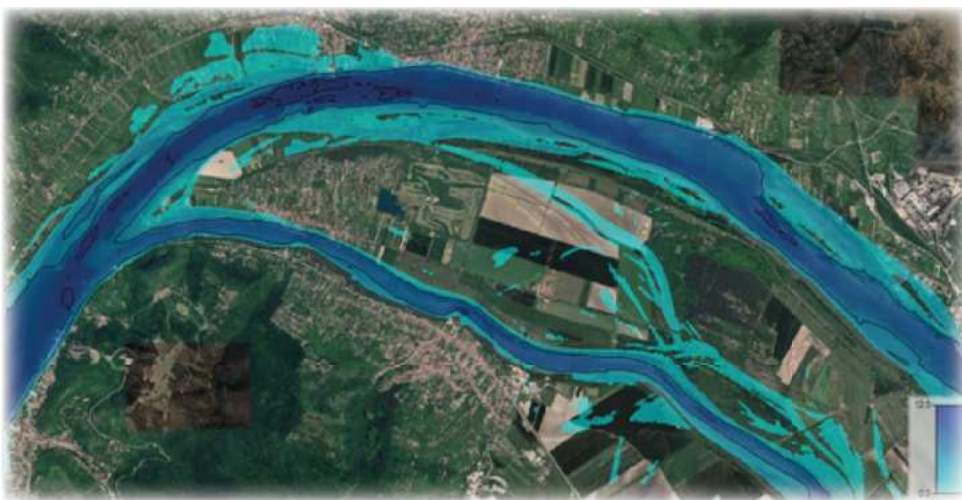
9. ábra HEC-RAS modelleredmény az I. fokú árvízvédelmi készültségi szinthez tartozó vízhozam esetén
