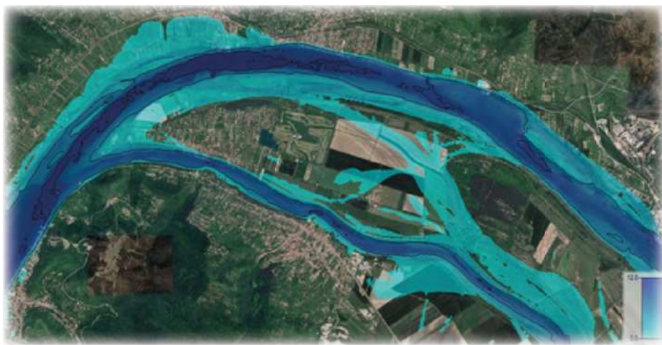
10. ábra HEC-RAS modelleredmény a II. fokú árvízvédelmi készültségi szinthez tartozó vízhozam esetén
