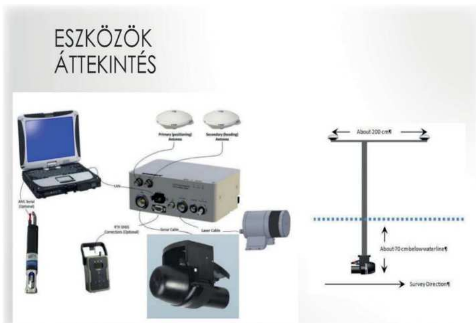
6. kép: Norbit iWBMS integrált multibeam mérőrendszer elemei
