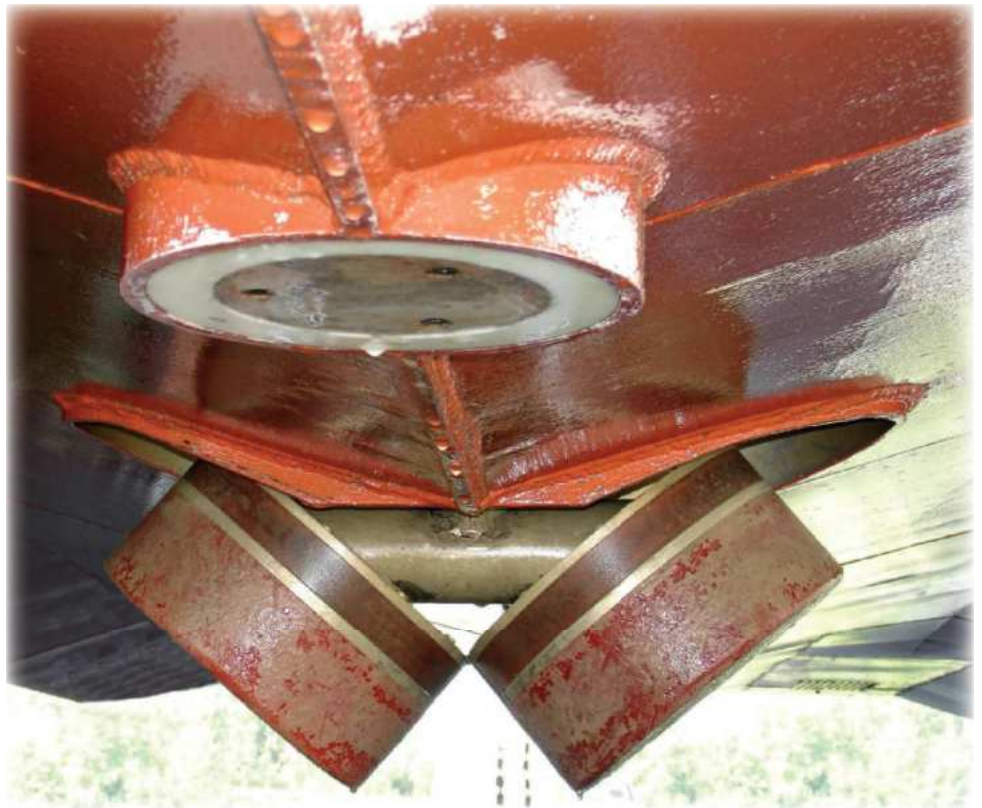
2. kép: Dr. Csoma János mérőhajó single- és multibeam mérőfeje
