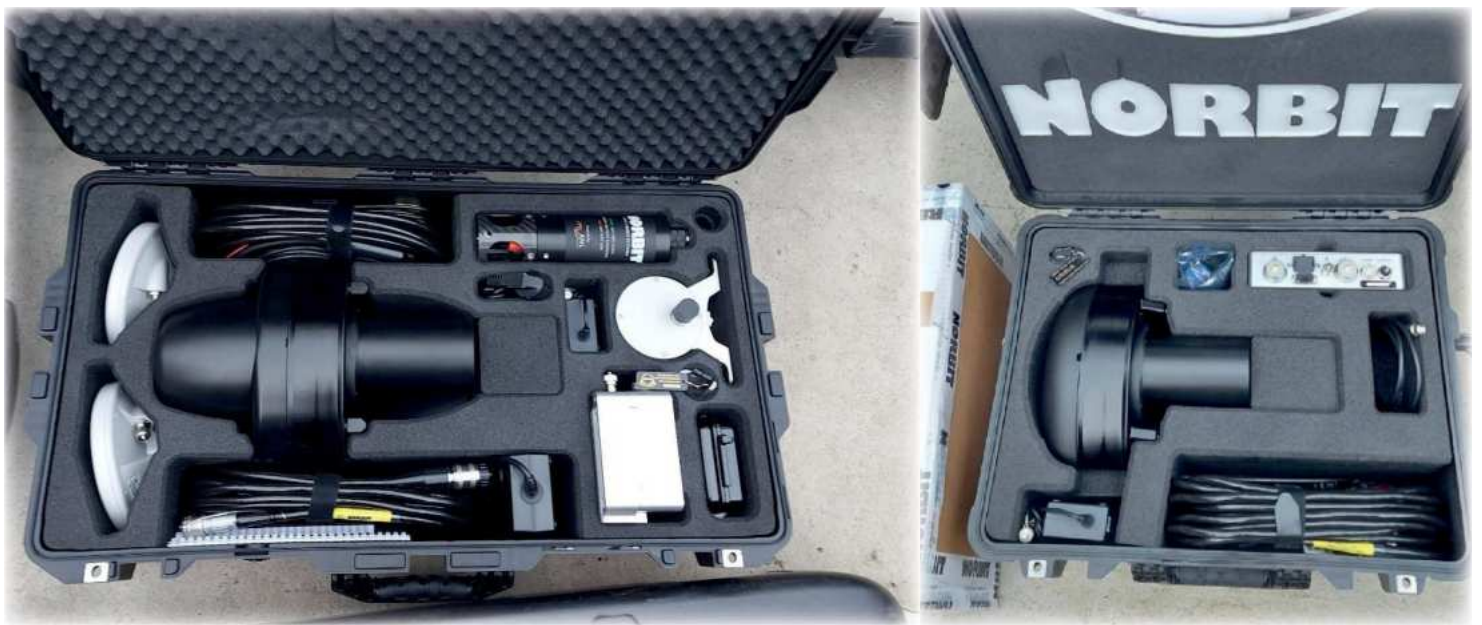
5. kép: Az elsődleges és a másodlagos mérőfej és tartozékai hordtáskákban
